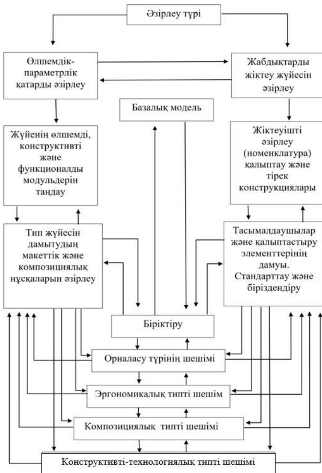
2 сурет. Өлшемдік - параметрлік қатардың мәндері бойынша базалық модельді әзірлеу және оны дамыту әдісімен типті құру әдістемесінің схемасы.
